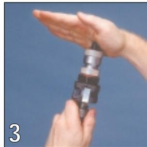
Durch leichtes Drücken mit dem Handballen auf die Kappe lösen Sie den Spannbolzen und bringen den Gewindeschaft in die Ausgangsposition.
