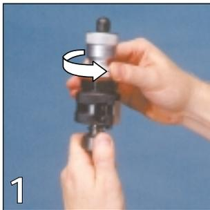
Fassen Sie den *multicut*\* mit der einen Hand am Einschraubgewinde und drehen Sie das Druckstück mit der anderen Hand so lange nach links (entgegen dem Uhrzeigersinn), bis sich die Schnittkante des Profilstahls in genügendem Abstand zum Gewindeschaft befindet (im Regelfall ca. 5–7 mm).
