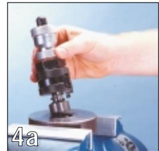
Das Gewinde der Einschraubbohrung darf keine Beschädigung aufweisen. Falls erforderlich, schneiden Sie mit einem geeigneten Gewindebohrer das Gewinde nach. Fassen Sie den *multicut*\* am Grundkörper und am Druckstück. Schrauben Sie ihn in die Einschraubbohrung.
