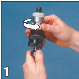
1 Saisissez le **multicut\*** d'une main sur le filetage à visser et tourner l'embout de l'autre main vers la gauche (dans le sens contraire des aiguilles d'une montre) jusqu'à ce que l'arête de coupe de l'acier profilé se trouve à un écartement suffisant de la tige filetée (généralement env. 5–7 mm).
