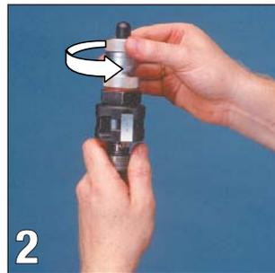
2 Saisissez le **multicut\*** d'une main sur le filetage à visser et tourner la bague de serrage de l'autre main vers la gauche (dans le sens contraire des aiguilles d'une montre) jusqu'à ce que vous ressentiez la butée. N'exercez aucune force!
