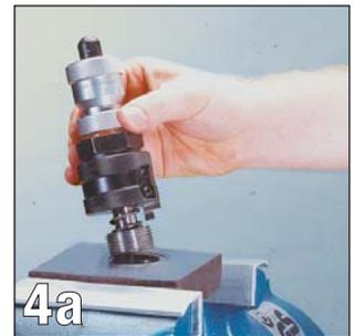
4a Le filetage du perçage ne doit présenter aucun endommagement. Si cela est nécessaire, rectifiez le filetage avec un taraud approprié. Saisissez le **multicut\*** sur le corps de base et sur la embout. Vissez-le dans le perçage fileté.
